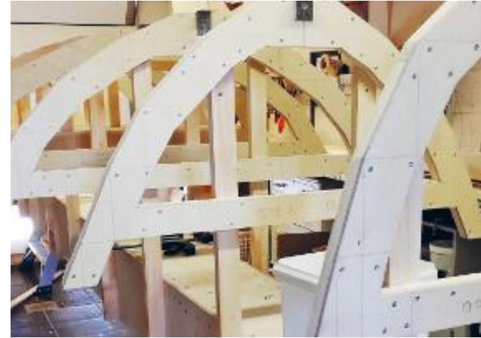
↑ Veneen muotokaaret on asennettu ja tästä lähtee sen kasaus käyntiin.
